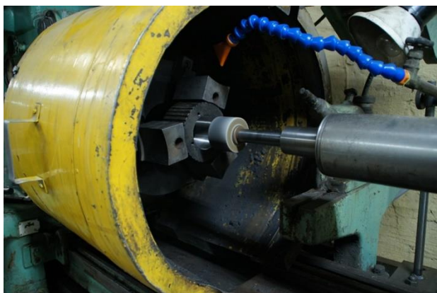
Шлифовка посадочных мест подшипников в роликах (бегунов)
