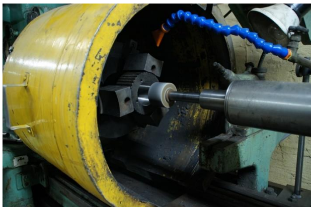
Шлифовка посадочных мест подшипников в роликах (бегунов)
