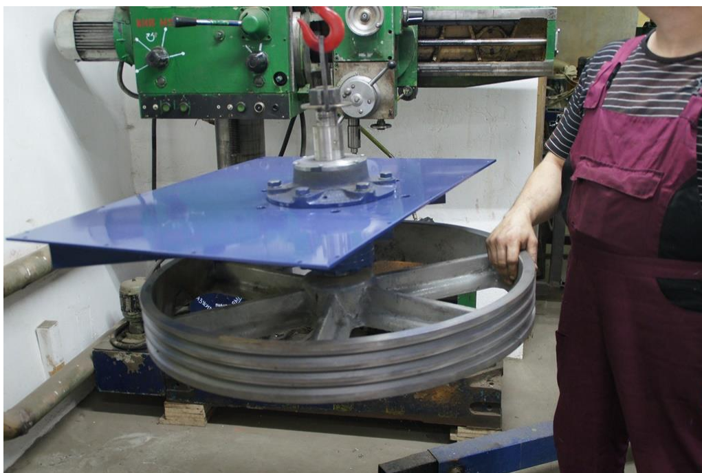
Силовой узел гранулятора
