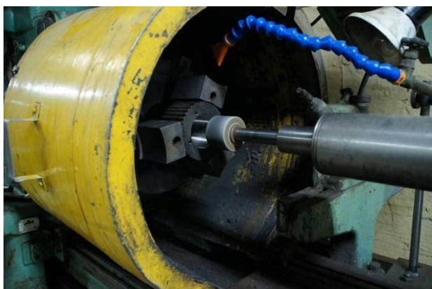
Шлифовка посадочных мест подшипников в роликах (бегунов)
