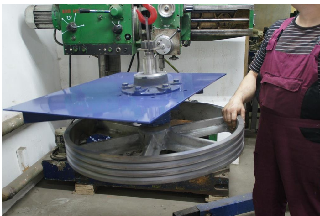
Силовой узел гранулятора
