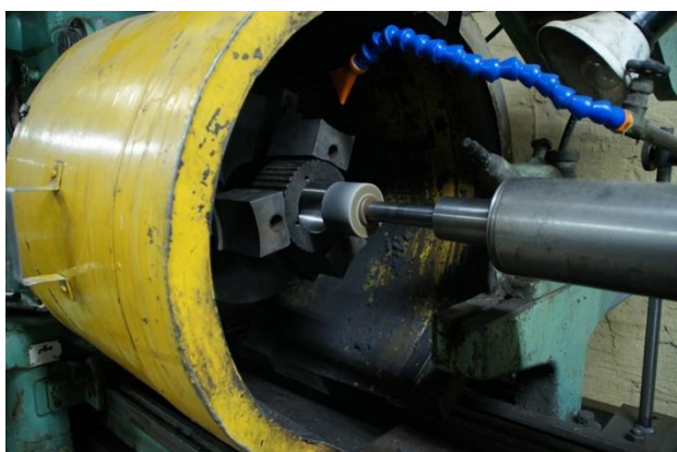
Шлифовка посадочных мест подшипников в роликах (бегунов)
