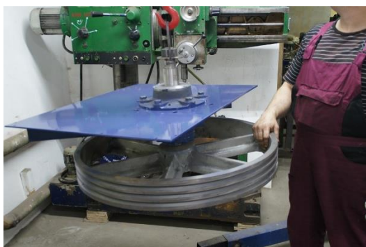
Силовой узел гранулятора
