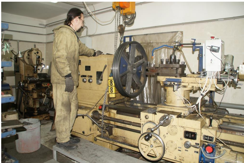
Изготовление маховика гранулятора
