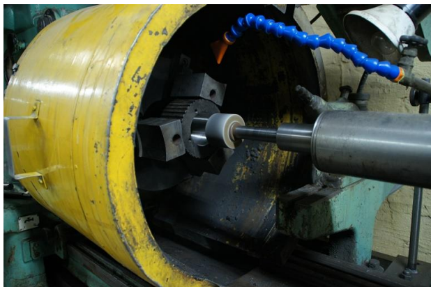
Шлифовка посадочных мест подшипников в роликах (бегунов)
