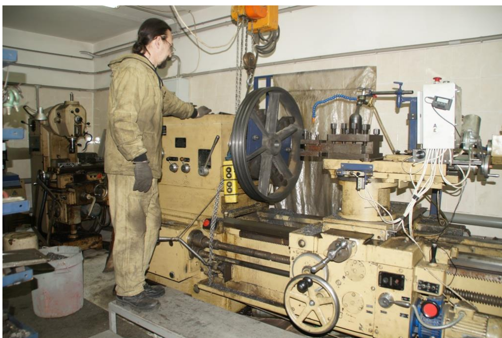
Изготовление маховика гранулятора
