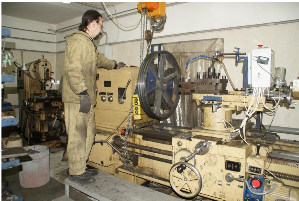
Изготовление маховика гранулятора
