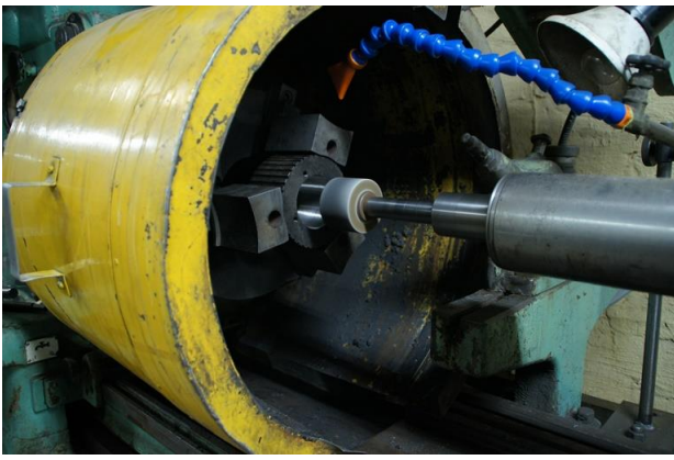
Шлифовка посадочных мест подшипников в роликах (бегунов)
