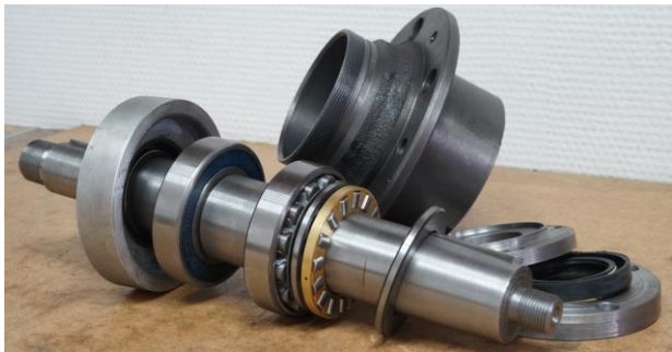
Устройство узла гранулятора
