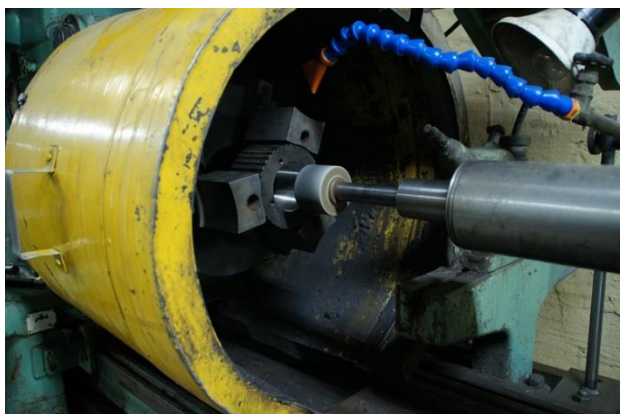
Шлифовка посадочных мест подшипников в роликах (бегунов)
