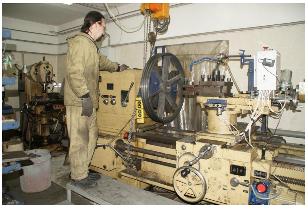
Изготовление маховика гранулятора
