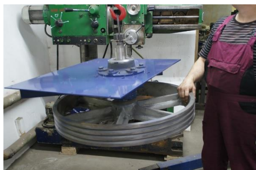
Силовой узел гранулятора
